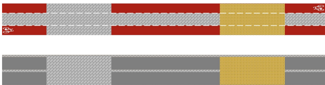
Figuur 2. Voorbeeld wegvak tussen kruispunten en oversteekplaatsen ter voorkoming eentonig beeld van rijbaan - boven: met fietsers op de rijbaan - onder: zonder fietsers op de rijbaan
